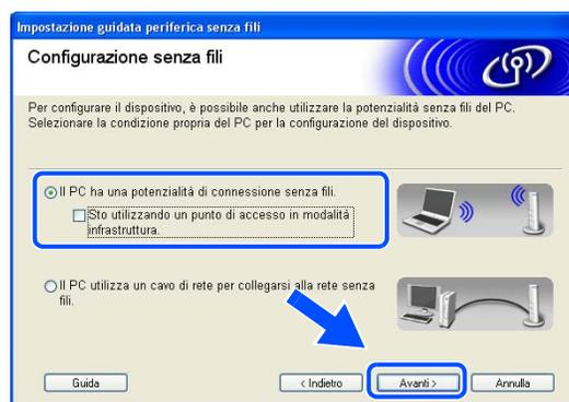
**10** È necessario modificare temporaneamente le impostazioni senza fili del PC. Seguire le istruzioni visualizzate sullo schermo. È importante prendere appunti di tutte le impostazioni, ad esempio il SSID o il canale del PC, nel caso fosse necessario ripristinare le impostazioni senza fili originali.
