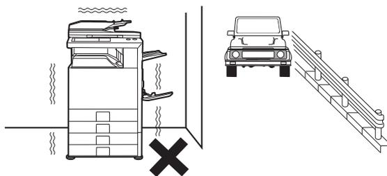
**⚠ Nella macchina è incorporato un disco rigido. Non sottoporre la macchina a colpi o vibrazioni. In particolare, non spostare mai la macchina quando è accesa.**
