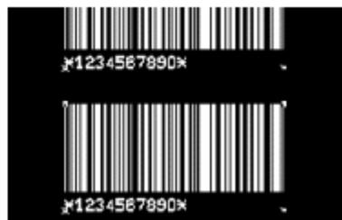
Attivando la funzione "Ottimizzazione" il nastro di trasferimento si consuma solo per la parte utilizzata per la stampa.
