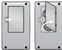
**[2] Retirez et installez la première pile :** pour retirer la pile usagée, utilisez un outil non métallique au point A pour débloquer la pile. Installez la nouvelle pile avec le signe positif (+) orienté vers le haut, vous faisant face.
