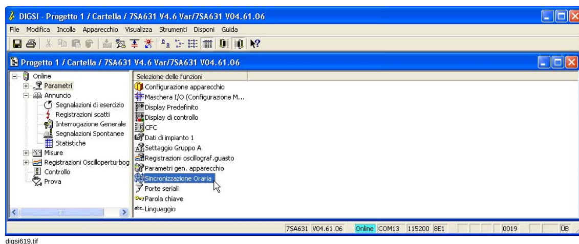
Fig. 5-78 Finestra della parametrizzazione in DIGSI 4 — Esempio
