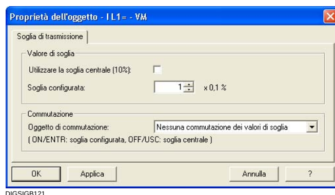
Fig. 5-27 Esempio di registro Soglia di trasmissione
