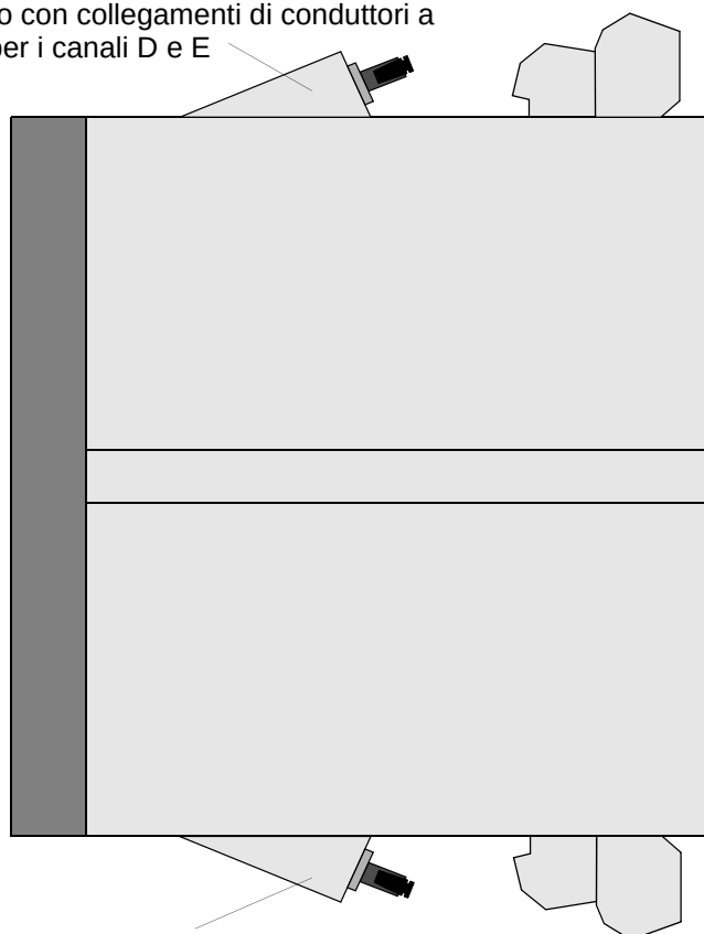
Fig. 2-28 Vista laterale di un montaggio sporgente con collegamenti per conduttori a fibre ottiche (equipaggiamento max.)
