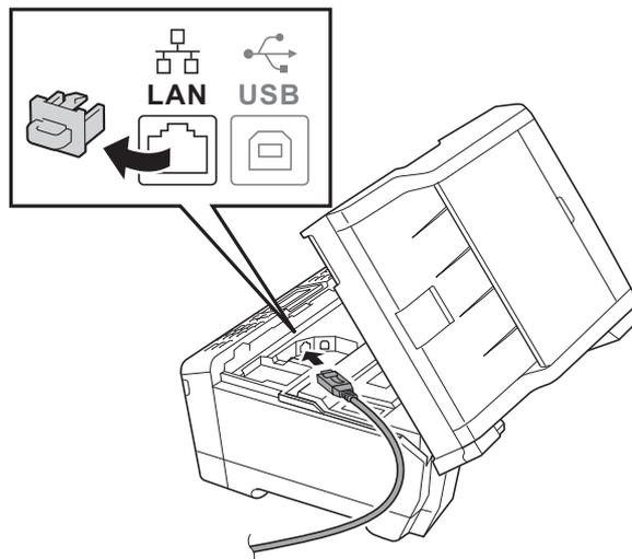
**c** Prestando la dovuta attenzione, far passare il cavo di rete nell'apposita canalina fino all'uscita sul retro dell'apparecchio. Collegare il cavo alla rete.
