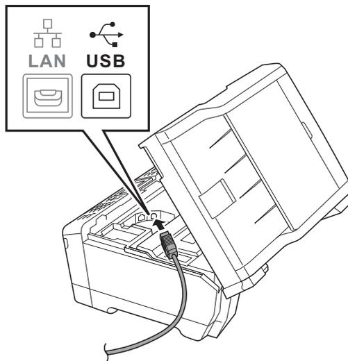
**c** Prestando la dovuta attenzione, far passare il cavo USB nell'apposita canalina fino all'uscita sul retro dell'apparecchio. Collegare il cavo al computer.
