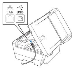
Prestando la dovuta attenzione, far passare il cavo USB nella canalina come mostrato di seguito, disponendo il cavo intorno e verso il lato posteriore dell'apparecchio. Quindi, collegare il cavo al computer.
