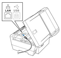
Inserire accuratamente il cavo di rete nella canalina come mostrato di seguito, disponendo il cavo intorno e verso il lato posteriore dell'apparecchio. Quindi, collegare il cavo alla rete.
