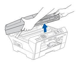
Collegare il cavo USB al connettore USB contrassegnato con il simbolo . Il connettore USB si trova all'interno dell'apparecchio sulla destra, come illustrato qui di seguito.
