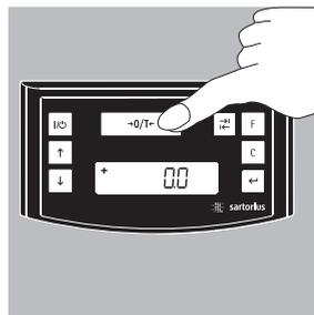
Dopo l'accensione della bilancia viene eseguita automaticamente un'autodiagnosi. L'autodiagnosi termina con l'azzeramento del display: **0,0 g**.
