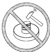
Non chiudere mai il contenitore di vernice con il martello fino a quando è ancora sul piatto di pesata! Il sistema di pesatura ne verrebbe danneggiato!
