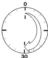
Dopo la connessione della bilancia alla rete elettrica e prima di procedere alla regolazione, attendere ca. 30 minuti per il preriscaldamento dell'apparecchio.
