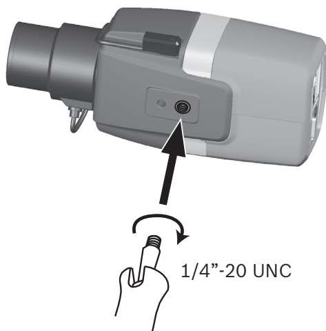
Immagine 5.2 Installazione di una telecamera
