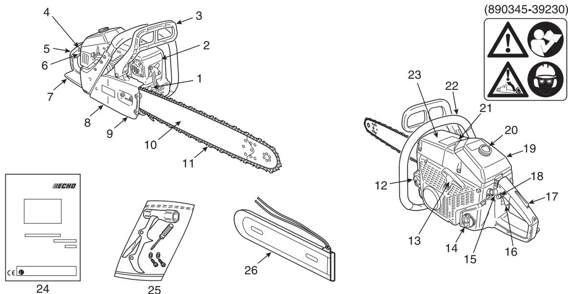
1. **Rampone** - Dispositivo, montato davanti al punto di montaggio della barra guida, che agisce da perno se a contatto con un albero o un tronco.
