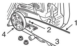
1. Scanalatura      2. Foro olio      3. Barra guida      4. Ingranaggio
