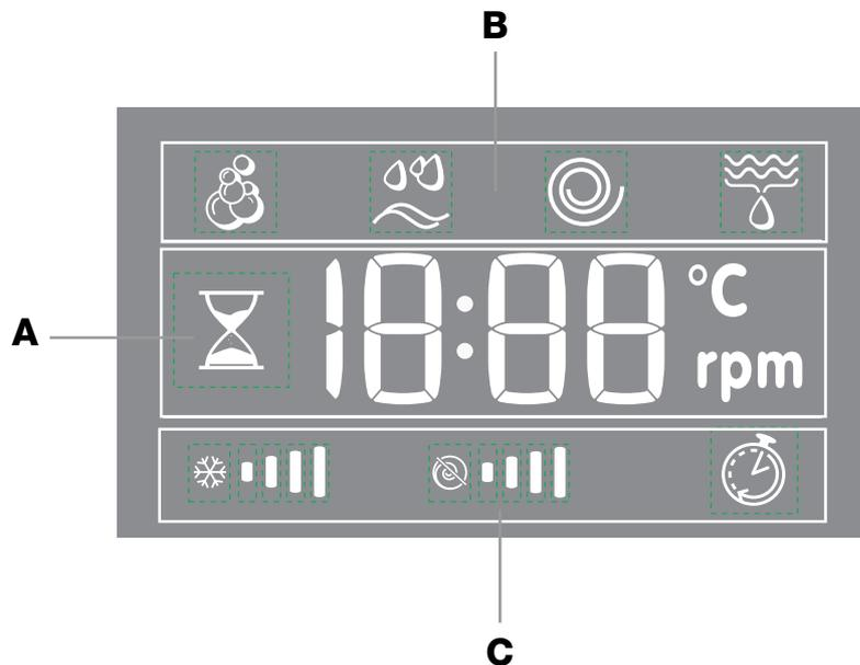
Il display è utile per programmare la macchina e fornisce molteplici informazioni.
