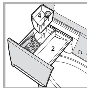
Questa funzione è utile per eliminare le macchie più resistenti. Inserire la vaschetta aggiuntiva **4**, in dotazione, nello scomparto **1**. Nel dosare la candeggina non superare il livello "max" indicato sul perno centrale (vedi figura). Per effettuare solo il candeggio versare la candeggina nella vaschetta
