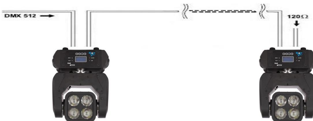
Utilizzare un cavo conforme alle specifiche EIA RS-485: bipolare intrecciato, schermato, 120Ohm di impedenza caratteristica e bassa capacità (PROEL DMXD – DMXD1).
