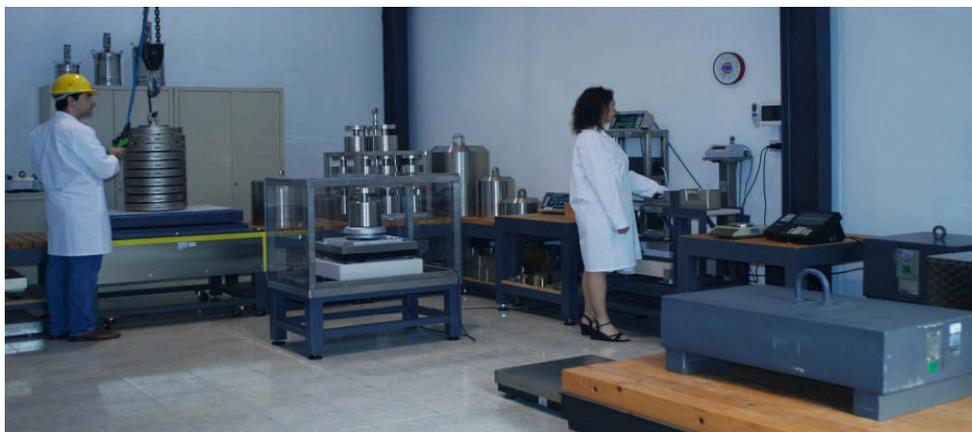
Laboratorio SIT per la taratura masse di grande capacità: da 50kg a 2000 kg
