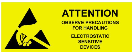
All'interno della copertura di protezione si trovano componenti che possono danneggiarsi, se toccati. Prima di eseguire interventi di manutenzione, l'addetto deve collegarsi a terra in conformità alle prescrizioni.
