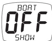
Consente allo strumento di visualizzare informazioni quando NON fa parte di un sistema Micronet, ma solo a scopo dimostrativo. Una volta spento, lo strumento ritornerà all'impostazione di default **Off**.
