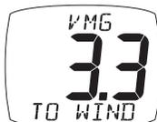
Velocità d'avanzamento dell'imbarcazione verso il vento. Questo valore viene calcolato dallo strumento in base alla velocità della barca e all'angolo del vento.
