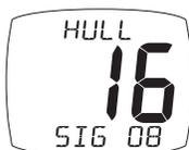
Visualizza la versione software (caratteri grandi), l'intensità del segnale e lo stato di carica/ricarica della batteria della centralina interna come supporto per individuare problemi e malfunzionamenti.
