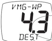
Velocità d'avanzamento dell'imbarcazione verso il waypoint attivo. Questo valore viene calcolato dal ricevitore GPS.
