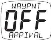
Imposta lo strumento in modo che l'allarme suoni quando il GPS emette un allarme per arrivo al waypoint
