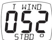
Angolo del vento vero rispetto all'imbarcazione, calcolato dallo strumento in base alla velocità dell'imbarcazione sull'acqua. Per effettuare questo calcolo devono essere disponibili in rete la velocità del vento apparente, l'angolo del vento e la velocità dell'imbarcazione.
