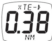
La distanza tra la posizione corrente e la linea ideale di rotta. La freccia indica la direzione verso la quale virare per rientrare nella rotta al waypoint.
