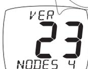
Mostra la versione del software e l'identificativo Micronet "Node", necessari per richiedere assistenza e individuare i guasti. Se lo strumento è il "Master" (quello che viene acceso per primo, e diventa quello principale), sarà visualizzato il numero di unità (nodes) nel sistema. Se lo strumento è uno "Slave" (cioè subordinato, attivato dal sistema), sarà visualizzata la potenza del segnale al "Master".
