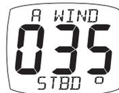
Angolo del vento apparente rispetto all'imbarcazione, misurato dal trasduttore in testa d'albero.
