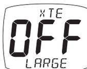
Imposta lo strumento in modo che l'allarme suoni quando il GPS emette un allarme per errore notevole di fuori rotta.
