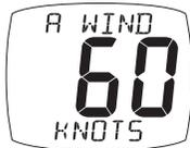
Velocità del vento apparente misurata rispetto all'imbarcazione dal tramittitore in testa d'albero.
