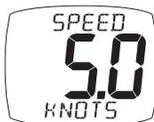
Velocità effettiva dell'imbarcazione sull'acqua, rilevata dal trasduttore di velocità.
