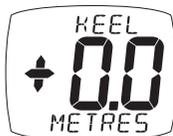
La compensazione della profondità consente di aggiungere la compensazione della chiglia in modo che la lettura dello strumento indichi la profondità dal fondo della barca, oppure la compensazione della linea di galleggiamento in modo che la lettura della profondità indichi la profondità effettiva dell'acqua. Per la calibrazione vedere pagina 29 sezione 4.1.
