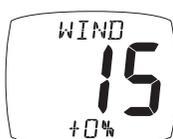
Aggiunge una percentuale che rettifica l'informazione ricevuta dal sensore della velocità del vento e garantisce la corretta visualizzazione della velocità apparente del vento. Per la calibrazione vedere pagina 31 sezione 4.3.
