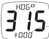
Allinea i gradi bussola visualizzati ai gradi bussola magnetica effettivi dell'imbarcazione. Per la calibrazione vedere pagina 32 sezione 4.4.
