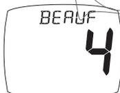
Velocità effettiva del vento sull'acqua, visualizzata secondo la scala Beaufort, calcolata dallo strumento in base alla velocità dell'imbarcazione nell'acqua e ai gradi bussola. Per effettuare questo calcolo devono essere disponibili la velocità del vento apparente e l'angolo del vento. Se si dispone del dato bussola verrà indicata anche la provenienza del vento.
