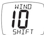
Il periodo di tempo entro il quale il sistema deve determinare la direzione principale del vento, può essere impostato da 2 a 60 minuti.
