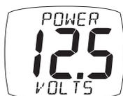
Intensità dell'alimentazione collegata alla Centralina Interna o all'Interfaccia Wireless.
