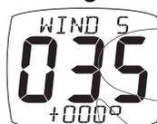
Allinea l'angolo del vento apparente visualizzato alla direzione del vento vero rispetto all'imbarcazione. Per la calibrazione vedere pagina 31 sezione 4.3.
