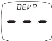
Per quanto correttamente posizionato possa essere il trasduttore della bussola, c'è sempre la probabilità di errori dovuti all'imbarcazione o alle apparecchiature. Per eliminare tali errori, è necessario "far oscillare" la bussola girando lentamente l'imbarcazione fino a quando il sistema riesce a ottimizzare la lettura. Una volta completata la correzione, verrà visualizzato il valore correttivo della deviazione. Per la calibrazione vedere pagina 32 sezione 4.4.
