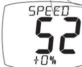
Aggiunge una percentuale che corregge l'informazione ricevuta dall'etichetta e garantisce la corretta visualizzazione della velocità dell'imbarcazione. Vedere pagina 30 sezione 4.2 la procedura di calibrazione.
