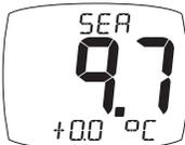
Aggiunge un valore che corregge l'informazione ricevuta dal sensore termico e garantisce la corretta visualizzazione della temperatura dell'acqua.
