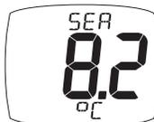
Temperatura attuale del mare, misurata dal sensore del trasduttore di velocità.
