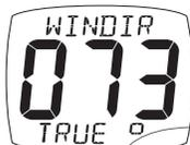
Direzione del vento vero sull'acqua, calcolata dallo strumento in base alla velocità dell'imbarcazione sull'acqua e ai gradi bussola. Per effettuare questo calcolo devono essere disponibili in rete la velocità del vento apparente, l'angolo del vento e i gradi bussola.
