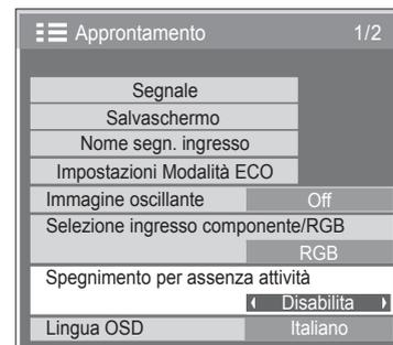
Quando questa funzione è impostata su "Abilita", l'alimentazione viene interrotta automaticamente (standby) in caso di inattività dello schermo per 4 ore.
