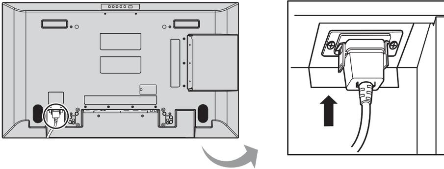
Collegamento alla presa a muro della rete elettrica
