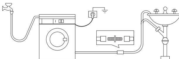
**In una condotta di scarico situata ad un'altezza non inferiore a 60 cm e non superiore a 90 cm.**
