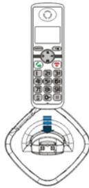
*Risultato:* quando si posiziona il portatile sulla base, esso si accende automaticamente e l'indicatore **Ricarica** si illuminerà durante la ricarica.
