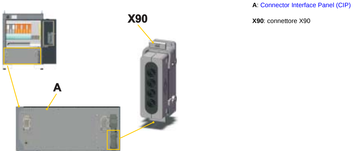
Fig. 4.11 - Connettore X90: composizione
