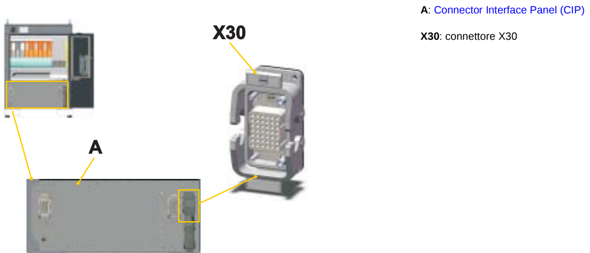
Fig. 4.8 - Connettore X30: composizione
