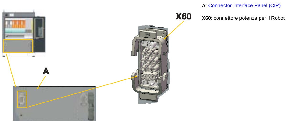
Fig. 4.2 - Connettore X60: composizione
