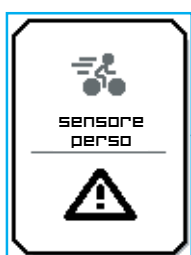
Collegamento con il sensore di velocità interrotto
