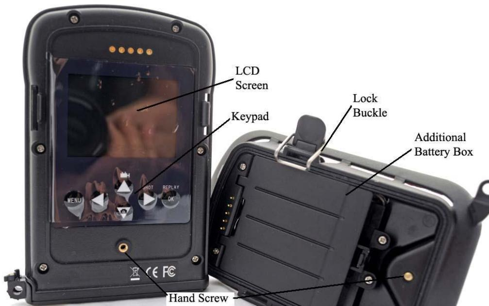
**Figura 1.3:** visione interna della fototrappola con porta batterie
