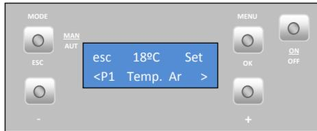
Per impostare la **temperatura di set-point dell'acqua** (solo per la **versione acqua**) nel programma P1, premere "set" e, appena inizierà a lampeggiare, premere il tasto "+" o "-" per selezionare la temperatura, quindi premere "ok" per confermare il dato.
