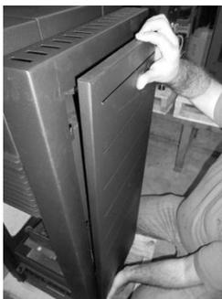
Figura 11 - Montaggio delle cappe laterali
