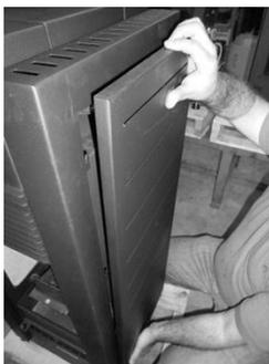
Figura 24 - rimozione delle cappe laterali
