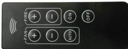
Figura 21 – comando con infrarossi
