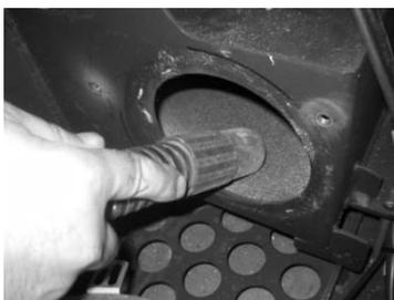
Figura 53 – Aspirare la zona di passaggio dell'aria
