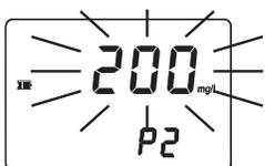
**Under range:** Un valore lampeggiante indica che il campione assorbe meno luce rispetto allo zero di riferimento. Controllare la procedura e assicurarsi di utilizzare la stessa cuvetta per zero e campione.
