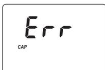
**Cap error:** Appare quando una quantità eccessiva di luce esterna entra nella cella di misura. Assicurarsi che il tappo sia correttamente avvitato sulla cuvetta.
