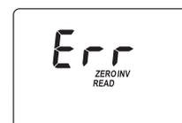
**Inverted cuvettes (cuvette invertite)**. Le cuvette del campione e dello zero sono state invertite.
