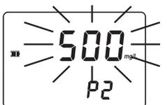
**Over Range:** Un valore lampeggiante della concentrazione massima indica un valore troppo alto. La concentrazione del campione è al di sopra della scala di misura: diluire il campione e rieseguire la misura.
