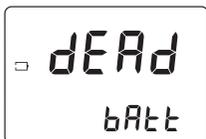
**Dead battery (batteria esaurita).** La batteria deve essere sostituita. Questo messaggio appare per alcuni secondi e poi il normale funzionamento dello strumento viene interrotto. Cambiare la batteria e riaccendere lo strumento.
