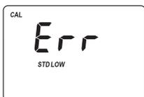
**Standard Low (standard basso).** La lettura dello standard è inferiore al valore previsto.
