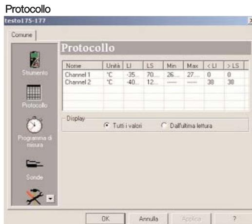
Nella finestra *Protocollo*, potete leggere le informazioni immagazzinate in tempo reale dal protocollo nel data logger. Potete scegliere due visualizzazioni diverse: *Tutti i valori* e *Dall'ultima lettura (time mark)*.
