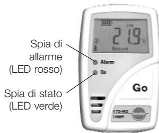
! E' possibile attivare/ disattivare le funzioni LED tramite il software **testo ComSoft**.
