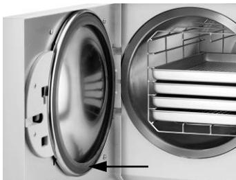
Se la guarnizione dello sportello si è ristretta o deformata, è necessario sostituirla.
