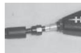
Assemblaggio del tubo del cilindro principale per i modelli HFX-Mag e HFX-Mag Plus
