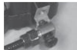
Assemblaggio del tubo flessibile della pinza G1
