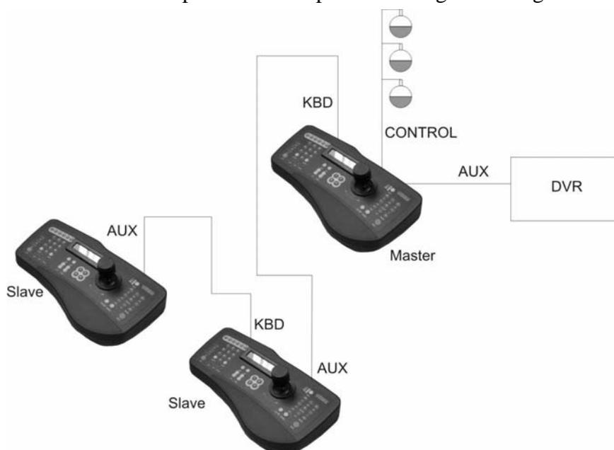
*Figura ii Un sistema campione di tastiere in cascata (unità singola)*
