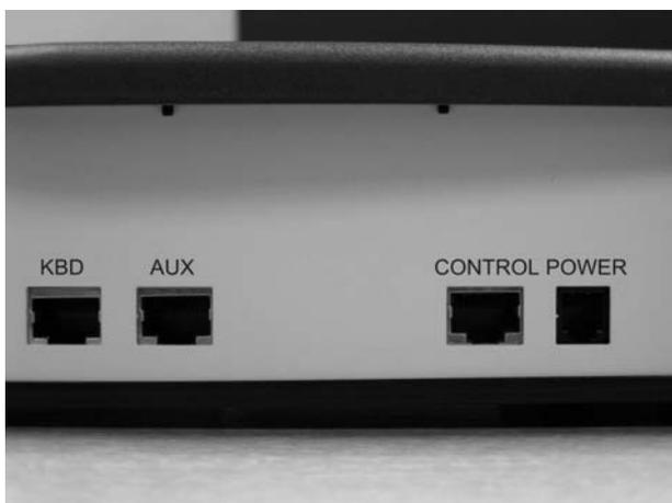
*Figura i* Vista posteriore del ricevitore di controllo del DVR e Multiplexer.
