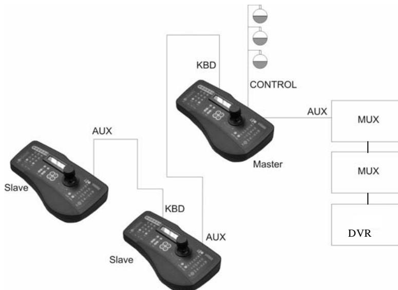
**Figura iii** Un sistema campione di tastiere in cascata (unità multiple)
