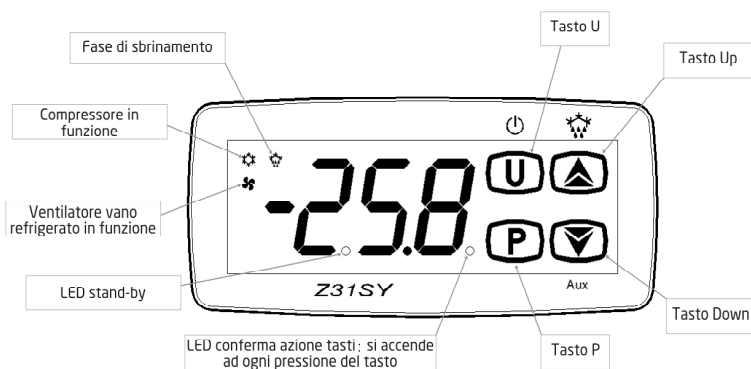
Fig.2 - Display del termostato: tasti e indicazioni di funzionamento
