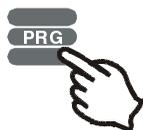
1. Premere una volta il tasto "PRG". (appare la scritta Opr sul display superiore)
