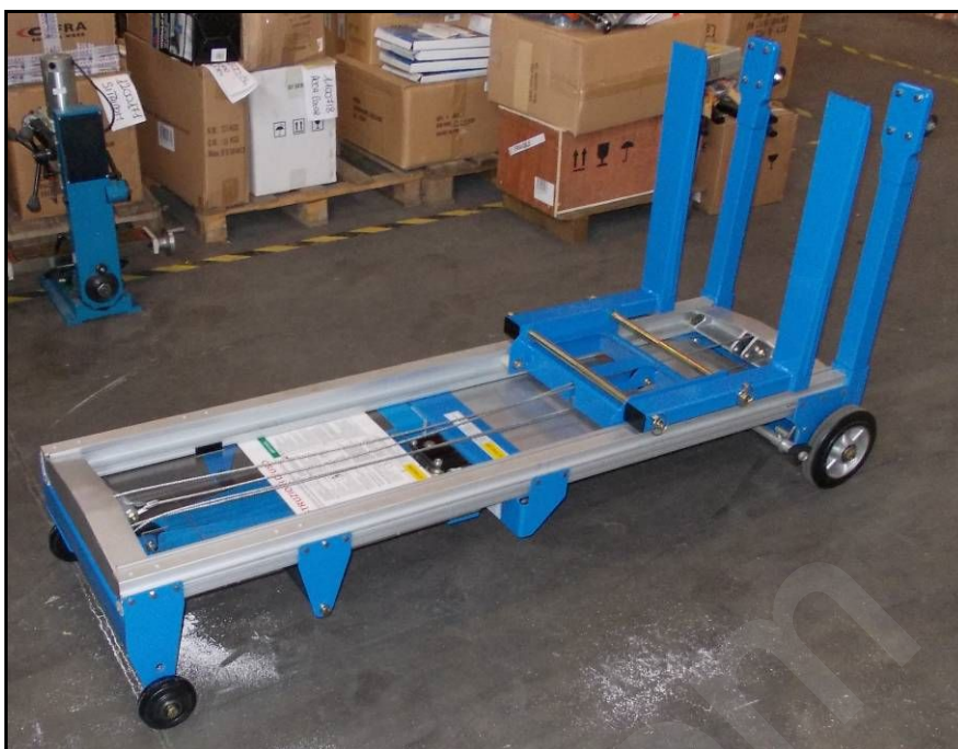
Figura 8 – Utilizzo del sollevatore in configurazione orizzontale.
