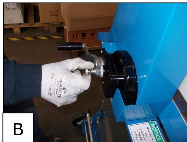
Figura 18 –Dettagli organo di sollevamento.
