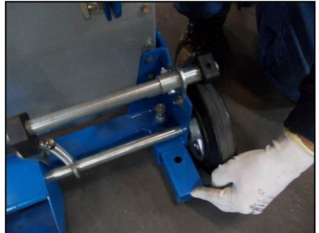
Figura 13 – Blocco del perno con il foro del supporto
