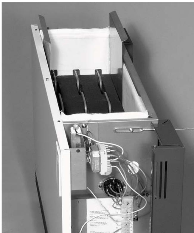
**3a** Con l'aiuto delle guide in lamiera, inserire gli elementi refrattari scanalati; prima gli elementi refrattari scanalati SP19 ed SP29, poi gli elementi refrattari scanalati SP39 ed SP40. Per il tipo e la quantità dei pacchetti di elementi refrattari si rimanda alla sezione "Caratteristiche tecniche".
