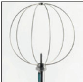
Fig.2 Sonda a filo caldo mod. HD2001.2.
