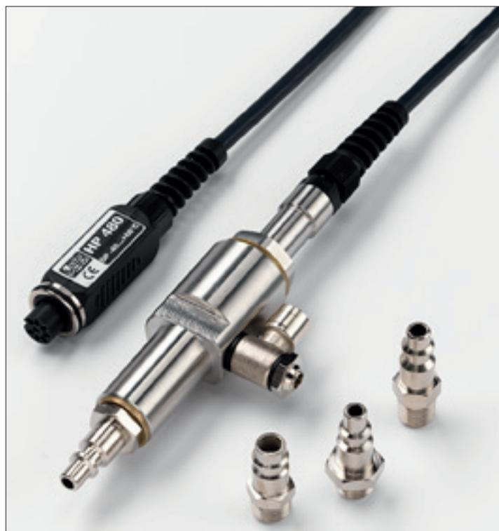
Le sonde possono essere installate in qualsiasi posizione. Il collegamento all'impianto di aria compressa può essere realizzato con un raccordo filettato o con un innesto rapido. La connessione con innesto rapido consente l'installazione e la rimozione della sonda senza fermare l'impianto. Sono forniti in dotazione 3 diversi innesti rapidi 1/4": standard italiano, tedesco e americano.
