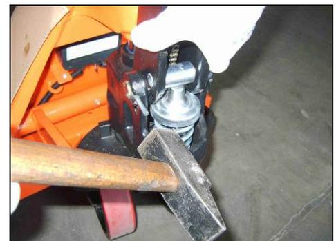
Figura 12 – Bloccaggio spina corta
