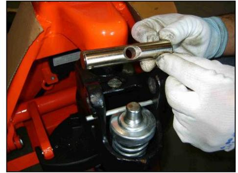
Figura 8 – Posizionamento perno.
