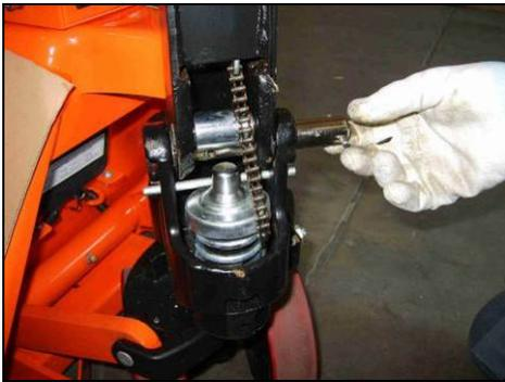
Figura 9 – Inserimento del perno.
