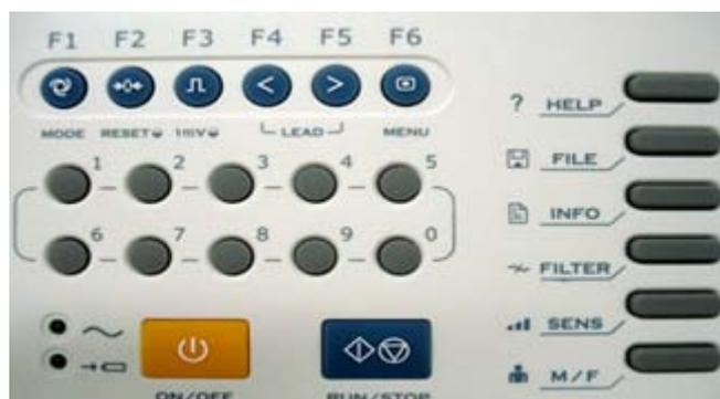
Figura 3-4 Pannello di Controllo dell'ECG-1112 Classe L
