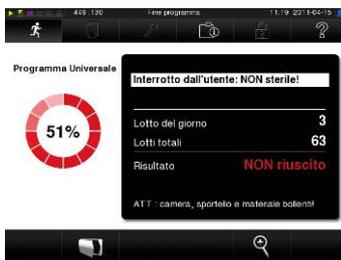
Se si interrompe un programma prima dell'inizio dell'asciugatura, gli →articoli da sterilizzare non sono ancora sterili.
