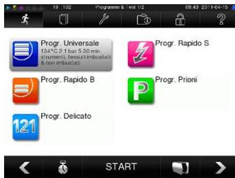
Se è stato selezionato un programma con i tasti di navigazione, questo appare evidenziato nel display. Ora è possibile azionarlo premendo il tasto START.
