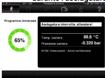
Durante la fase di asciugatura è possibile interrompere il programma con il pulsante **STOP** senza che l'autoclave registri un errore.
