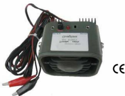
Riproduttore digitale amplificato a 10 canti programmabili e timer incorporato per predisporre l'accensione automatica. Canti selezionabili e riproducibili in ciclo continuo. Dotato di un altoparlante a tromba 4 OHM offre anche la possibilità di collegare altri due altoparlanti esterni per aumentare la potenza. Un regolatore analogico permette una pulita regolazione del volume, senza provocare sbalzi.
