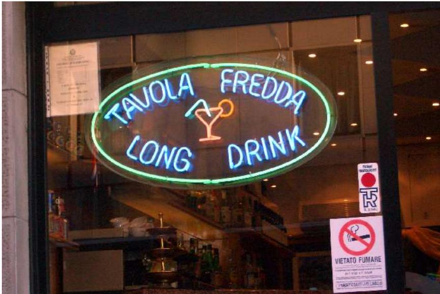
**Figura 3.** Nelle lampade fluorescenti come quelle delle insegne luminose la luce è emessa da gas a bassa pressione eccitati dal passaggio della corrente elettrica.
