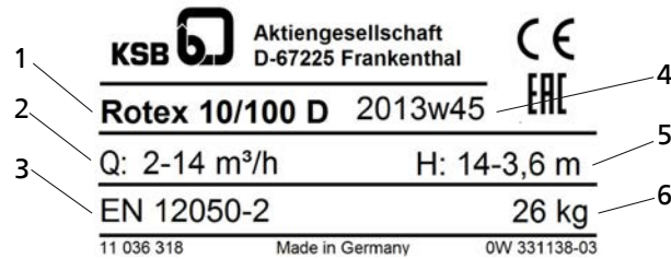
Fig. 2: Targhetta costruttiva MK (esempio)
