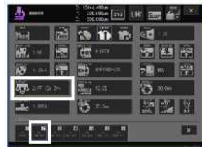
Sotto schermata bottone [NOSEPIECE]: impostazione 10x
