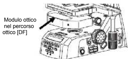
Portare il diaframma anulare campo scuro nel percorso ottico
