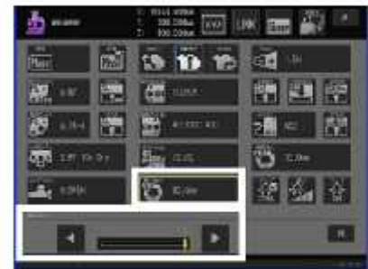
Sotto schermata bottone [APERTURE STOP]: regolazione del DIA diaframma di apertura
