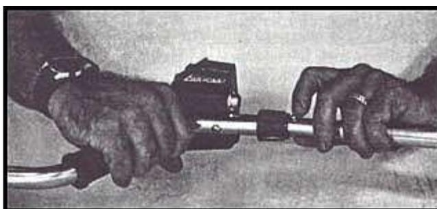
6. Slide polo inferiore in pole mezzo fino clicca sui bottoni in primavera la prima serie di fori di regolazione. Blocco Turn pole per stringere, in tal modo l'assemblea di bloccaggio in posizione.
