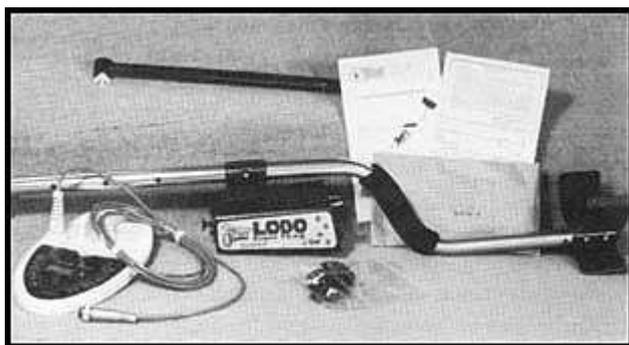
Assemblea della SuperTRAQ Lobo è semplice e non richiede attrezzi speciali. Basta installare le batterie, montare il searchcoil sul montaggio inferiore pole, collegare le tre assemblee pole, avvolgere il cavo in eccesso attorno al polo e collegare il cavo nella custodia di controllo. Infine, regolare la lunghezza del palo e l'angolo searchcoil e sei pronto!
