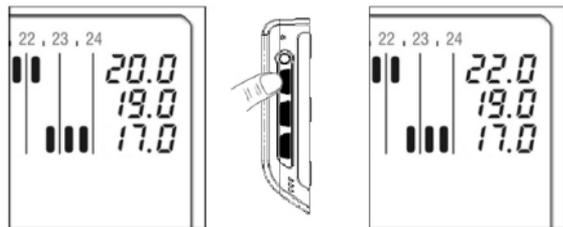
La **temperatura T2** non può essere superiore alla temperatura T3 o inferiore alla temperatura T1.
