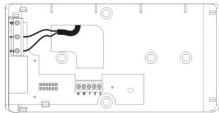
Collegare i due fili dell'impianto di riscaldamento o raffreddamento ai morsetti a vite 1 e 2, come mostrato in figura.
