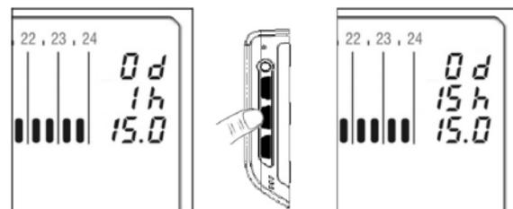
Per impostare i giorni («d») di durata del modo di funzionamento Jolly usare il selettore rotativo superiore.
