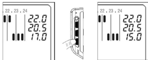
Se non è stata fatta alcuna personalizzazione, il modo di funzionamento automatico funziona con i profili di temperatura memorizzati: predefiniti (si veda «Programmi predefiniti»). Per personalizzare i profili si veda «Programmazione cronotermostato».
