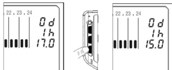
Per impostare le ore («h») di durata del modo di funzionamento Jolly usare il selettore rotativo centrale. Le ore possono variare da 0 a 23.
