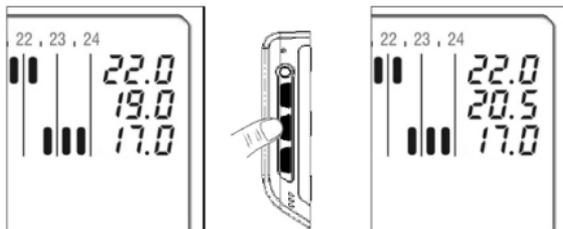
La **temperatura T1** non può essere superiore alla temperatura T2 o inferiore a 2 °C.
