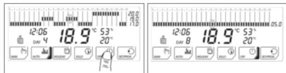
Il cronotermostato regola il funzionamento dell'impianto di riscaldamento per mantenere la temperatura Antigelo, allo scopo di diminuire i consumi energetici ed evitare contemporaneamente i danni causati da temperature troppo rigide.
