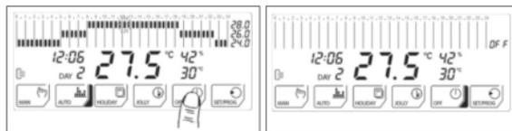
L'impianto si spegne completamente e sul display appare la scritta OFF, senza alcun profilo di temperatura.
