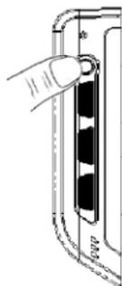
Per passare dal funzionamento invernale (impianto di riscaldamento) al funzionamento estivo (impianto di raffrescamento), e viceversa, tenere premuto per almeno 4 secondi il tasto Estate / Inverno. Il funzionamento selezionato viene indicato sul display dalle icone Inverno o Estate.
