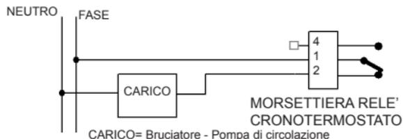
**Attenzione:** Verificare che il carico del relè non superi i valori indicati nelle «Caratteristiche tecniche».
