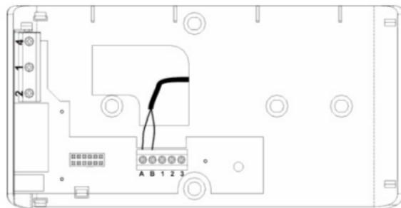
Collegare i due fili della sonda di temperatura separata ai morsetti a vite A e B, come mostrato in figura.
