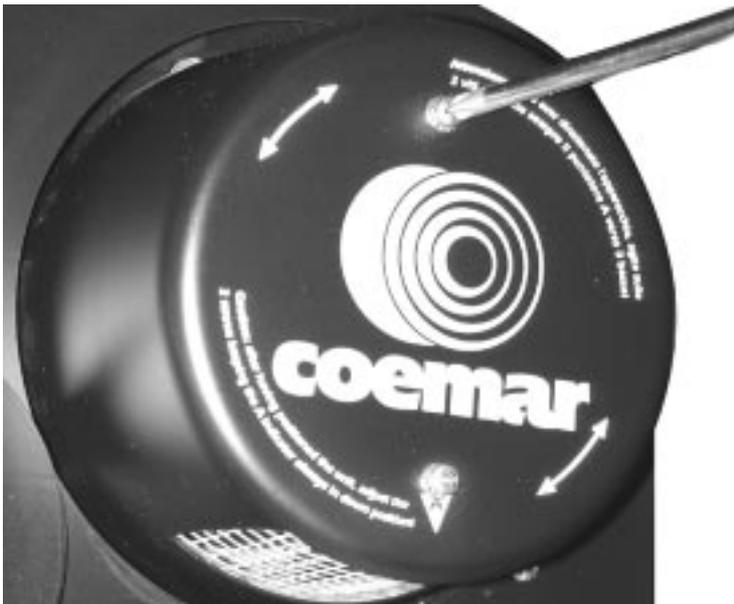
Le ventole di raffreddamento devono essere pulite almeno ogni 6 settimane. Per accedere alle ventole, poste ai lati del corpo proiettore, rimuovete i carter copriventole svitando le due di fissaggio. Eseguite la pulizia delle ventole di raffreddamento utilizzando un pennello ed un comune aspirapolvere oppure un generatore di aria compressa.
