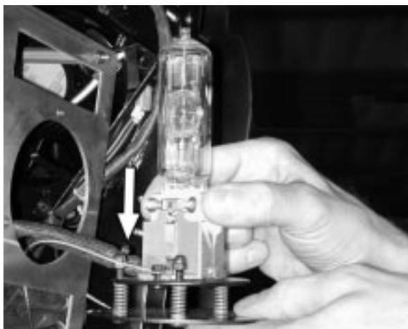
6) Inserite la lampada. La lampada usata è in vetro di quarzo e deve essere maneggiata con molta cura; attenetevi scrupolosamente alle istruzioni incluse nell'imballo della lampada. Non toccate direttamente il vetro, usate l'involucro di polietilene accluso nella scatola. Il portalampada GX 9,5 è simmetrico e la sua costruzione meccanica, di precisione. **NON FATE MAI FORZA** sul vetro; in caso di difficoltà ruotate la lampada e provate di nuovo.
