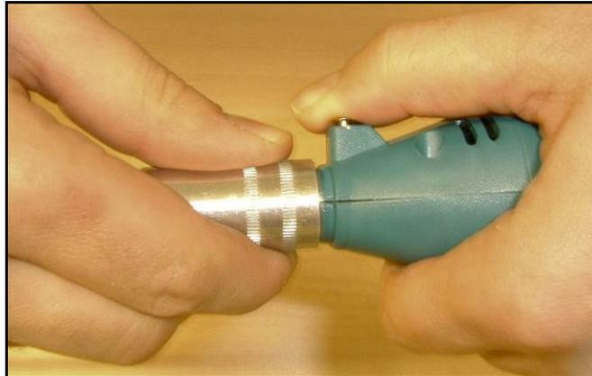
Figura 8 – Avvitamento dell'albero flessibile.
