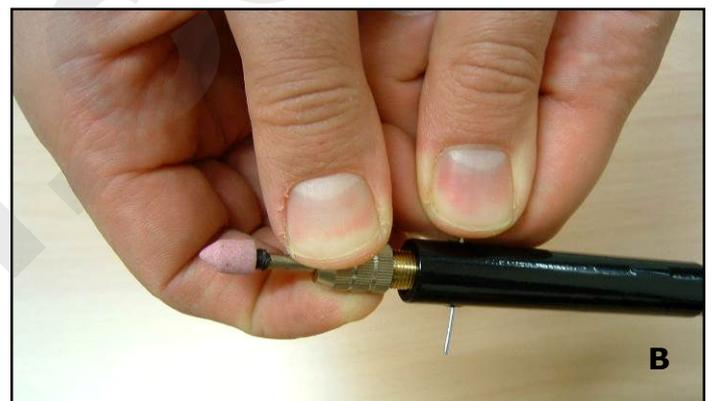
Figura 9 – Montaggio utensile sul tubo flessibile (A: vista generale – B: Serraggio ghiera).
