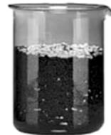
**La cartuccia di sali fosfati** previene la formazione di incrostazioni nel condensatore aggiungendo fosfato all' acqua di rubinetto. Adatta per durezza dell' acqua da 4° a 15° secondo la scala tedesca.
