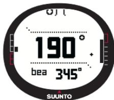
L'indicatore del rilevamento si sposta in un arco a 120° nella parte superiore del display. In caso la direzione dell'unità devii ulteriormente rispetto al rilevamento individuato, l'unità indica la direzione di svolta mediante le frecce. E' possibile seguire nuovamente il rilevamento con precisione, quando compare un cerchio sulla parte superiore del display. Premere nuovamente *Start/Data* per selezionare un rilevamento nuovo.
