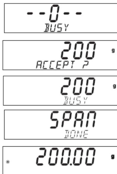
La lettura di zero è presa. Il prossimo display mostra il valore predefinito di calibrazione del valore del peso. Premere NO per passare a un peso di calibrazione alternativo. Premere SI, quando si è
