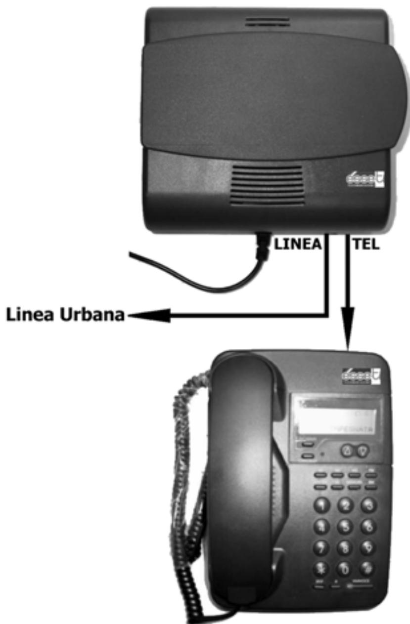
Tramite programmazione è possibile abilitare il modulo ad inoltrare automaticamente la chiamata su linea urbana o GSM.
