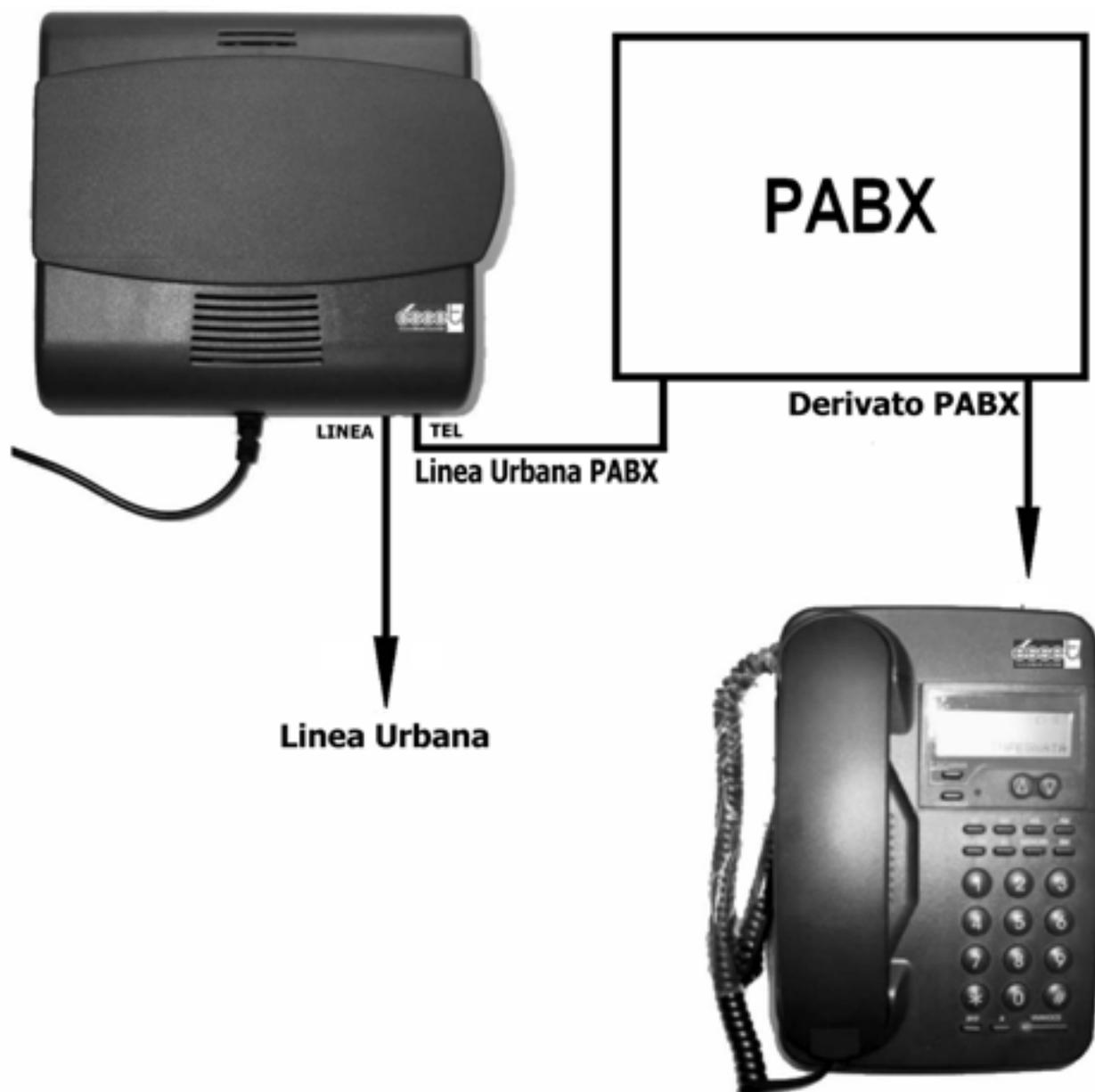
Qualsiasi telefono derivato del PABX può uscire sulla linea mobile del modulo. La selezione in automatico è possibile solo con PABX che offrono questo servizio.
