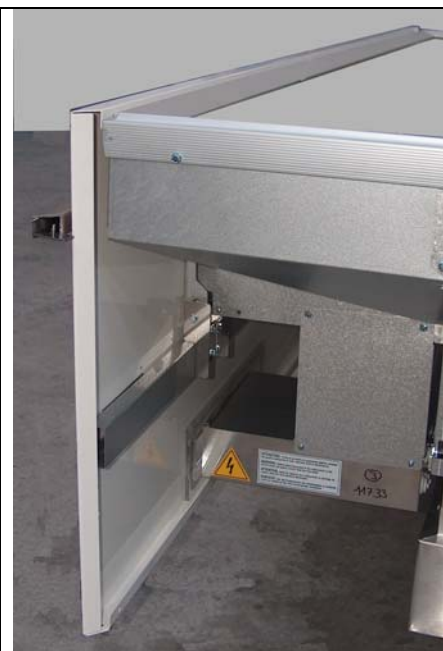
Fig. 4: pannello installato correttamente
