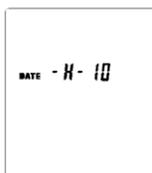
Quando sul display appare la modalità di regolazione del mese ("month"), premere "LEVEL" per effettuare la regolazione e premere "HOLD" per mantenere l'impostazione. Premendo il tasto "SETUP" una sesta volta, il display visualizza la schermata seguente:
